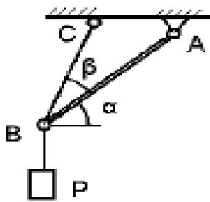
2. Груз весом  $P = 10 \text{ Н}$  подвешен на двух тросах  $AB$  и  $BC$ , составляющих с горизонтальной прямой углы  $\beta=15^\circ$  и  $\alpha=30^\circ$ . Определить усилия в тросах.
